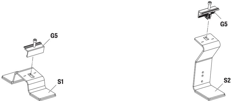
2. Schwerlaststützen mittig unter den PV-Modulen platzieren und die Endklemmen mit einem Drehmoment von 15 Nm festziehen
